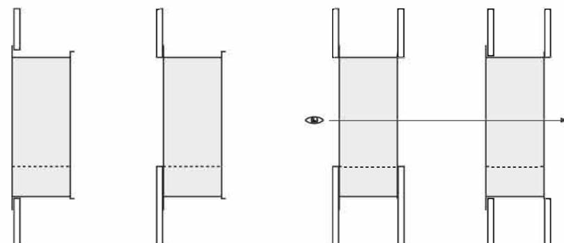
Sowohl die XL- als auch die XXL-Einbaukästen sind oben mit Metallrohren ausgestattet. Dadurch können Rohre an Heizgitter angeschlossen werden, um die Wärme zurück in den gewünschten Raum zu leiten. Wenn sie diese nicht benötigen oder wünschen, können sie diese leicht entfernen.
