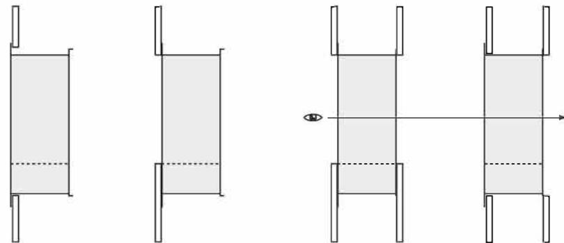
Zowel de XL als de XXL unit zijn uitgevoerd met metalen pijpen aan de bovenzijde. Hierdoor kunnen buizen naar ventilatieroosters worden aangesloten om de warmte terug te voeren naar de gewenste ruimte. Wanneer deze in uw toepassing niet noodzakelijk of wenselijk zijn kunnen deze eenvoudig verwijderd worden.
